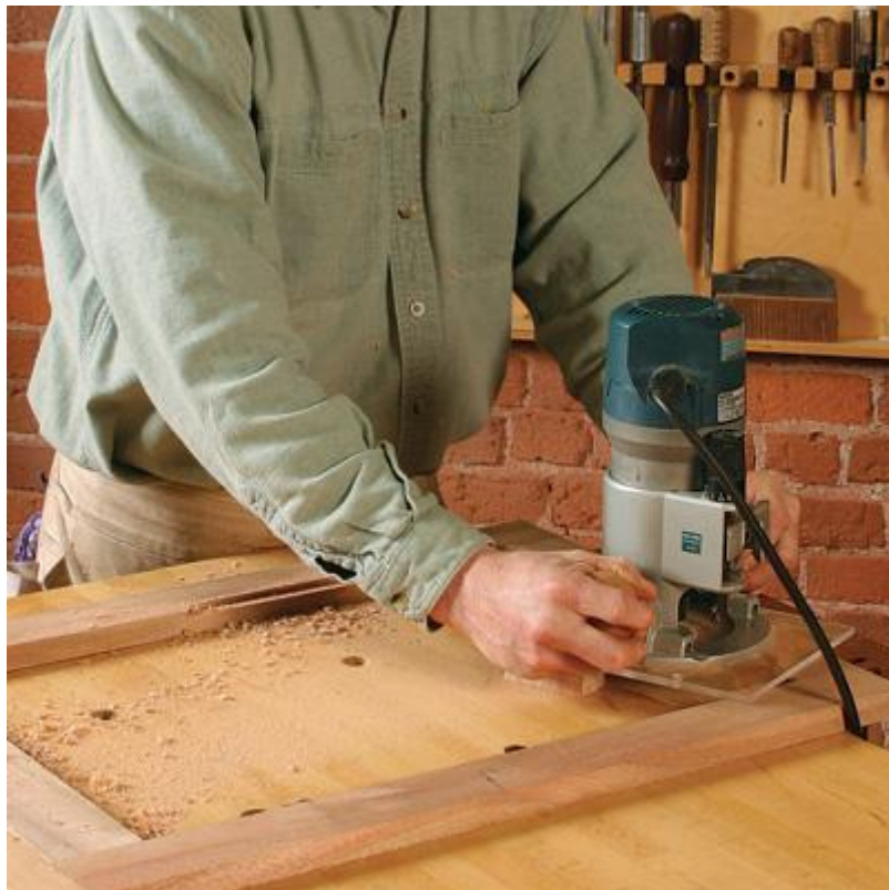
Esta ilustração nos mostra o uso da tupia manual com a guia.
